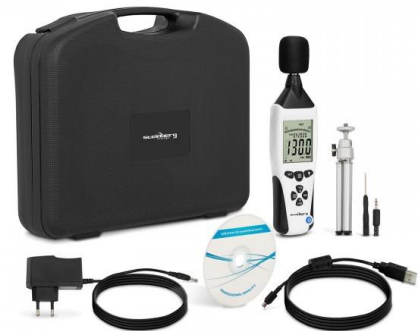
Figura 1- Modello di fonometro-frequenzimetro con accessori, capace di rilevare suoni di intensità compresa nell'intervallo da 30 a 130 dB (decibel) e la cui frequenza sia compresa tra 31,5Hz e 8KHz. (Fonometro professionale Steinberg. Immagine reperita in Internet).
